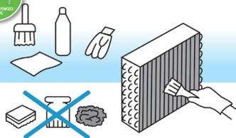
Les condensateurs sales utilisent plus d'énergie. Le condenseur est situé derrière la grille de ventilation. Nettoyez-le régulièrement avec une brosse douce.
